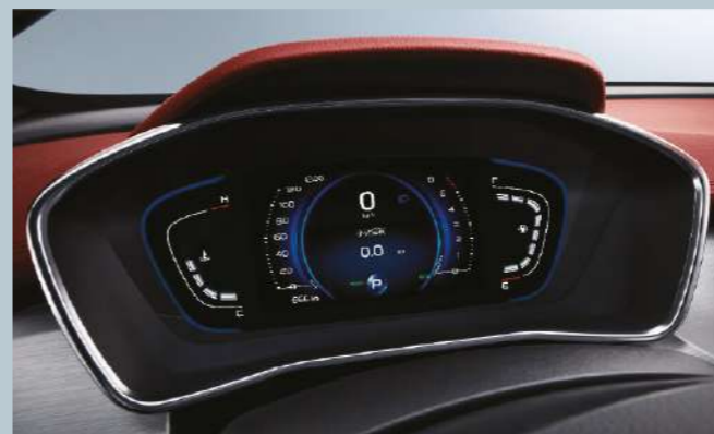
7-дюймовая цифровая приборная панель, изменяющая дизайн в зависимости от выбранного режима движения.
