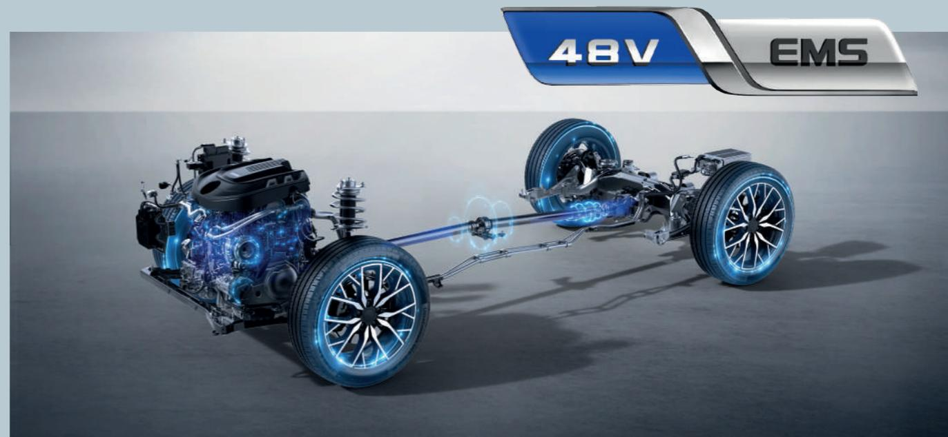
Система мягкого гибрида EMS (Electric Motor Synergy) обеспечивает эффективную совместную работу ДВС и стартер-генератора для мгновенного запуска двигателя и энергичного разгона, повышения суммарного крутящего момента
