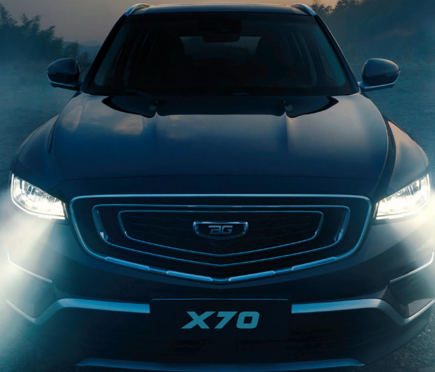
Мощные светодиодные фары<sup>1</sup> в сочетании с системой интеллектуального управления дальним светом<sup>1</sup> автоматически переключаются с дальнего на ближний свет при приближении к встречному либо попутному автомобилю.
